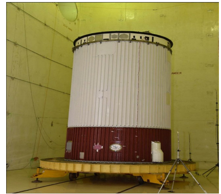
चित्र 18 ध्वनिक परीक्षण में पीएसएलवी घटक।
