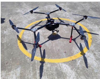
चित्र 12 इलेक्ट्रो मैग्नेटिक सर्वे का हेक्स-कॉप्टर।
